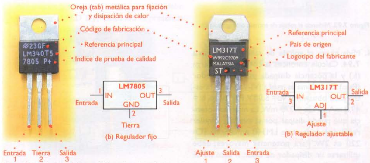
Figura 7.91. Identificando los reguladores de tres terminales
